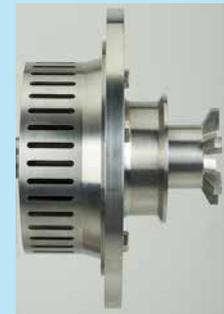
L'étage radial est constitué d'un rotor radial à haut débit qui se décharge à travers un stator à fentes, ce qui permet un cisaillement mécanique et hydraulique supplémentaire. La force centrifuge à ce stade permet au mélange d'être poussé loin de l'arbre et le long du rayon du stator, forçant une expulsion à grande vitesse au bord des fentes.
