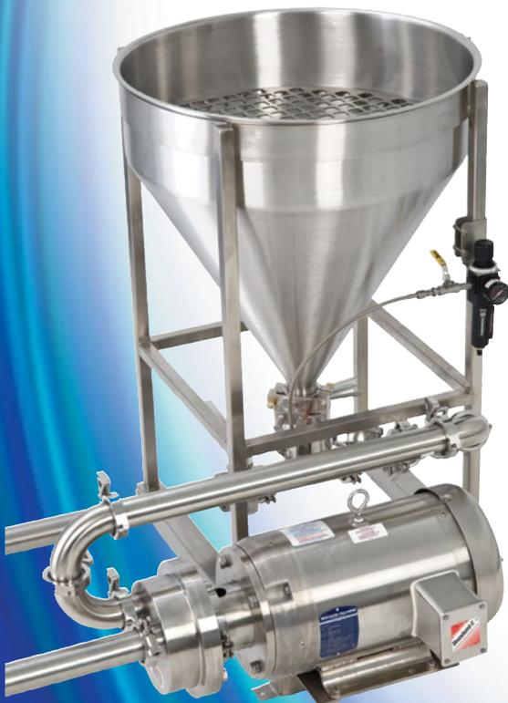
Standard OES-System inkl. eines 100 Liter fassenden Pulverbehälters und modularen Rahmens auf Fußbodenhöhe erleichtert den Zugang für die Zuführung von Zutaten
