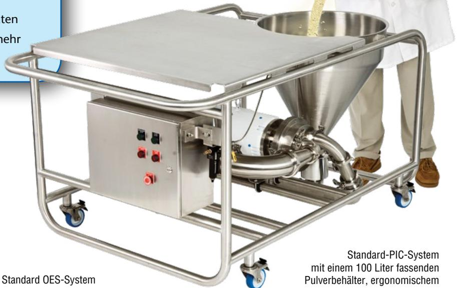
Standard-PIC-System mit einem 100 Liter fassenden Pulverbehälter, ergonomischem Arbeitstisch in Hüfthöhe, Pulversaugpumpe für Anwendungen mit hohen Hygieneanforderungen, Pulverventil, Vakuummeter, Vakuumregelventil, Steuerkasten für Pumpe und Verrohrung
